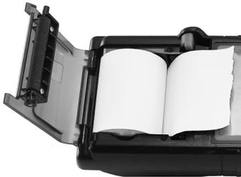
**Papier wird von unter der Rolle zugeführt**
