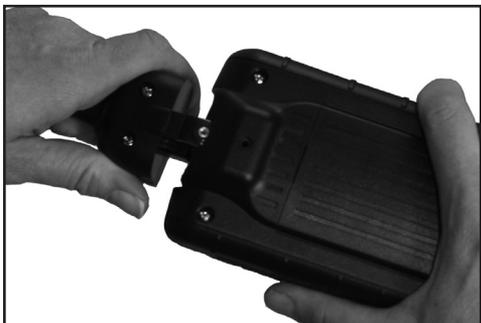
4. Ein neues Kabel schließen Sie an, indem Sie das Kabel und das Gehäuse des Testgeräts in die korrekte Position bringen und das Kabel einstecken. Setzen Sie die Schraube anschließend wieder ein, und ziehen Sie diese an.
