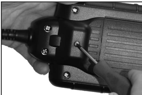
3. Halten Sie das Gehäuse fest, und ziehen Sie den Kabelaufbau aus dem Gehäuse.
